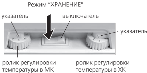
Рисунок 10 — Схема переключения режимов в холодильнике двухкомпрессорном или в однокомпрессорном холодильнике с клапаном
