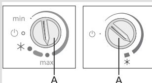
Поверните переключатель **A** по часовой стрелке в область, обозначенную толстой линией.
