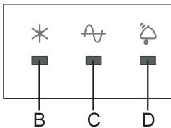
Включите прибор и поверните ручку термостата в положение «Быстрого замораживания» \* .
